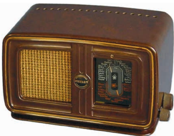
● Ingelen 142L, "Verlagerungsgerät" met het chassis van de Philips 203U, gebouwd door Philips in Eindhoven in de periode 1941/1942. In de ronde uitsparing op de brede middenstijl is het logo van de Oostenrijkse radiofabrikant Ingelen aangebracht. Foto: Gerhard Heigl (Oostenrijk).
