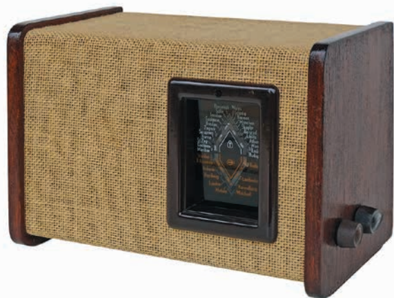
● Mediator M100U, gebaseerd op de Philips 203U, maar op diverse punten (kast, afstemschaal, chassis, achterwand) wel afwijkend van het basismodel. Foto: Torsten Stein (Duitsland).
